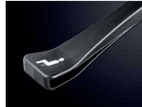
Die Bedienhebel mit selbsterklärenden Piktogrammen
